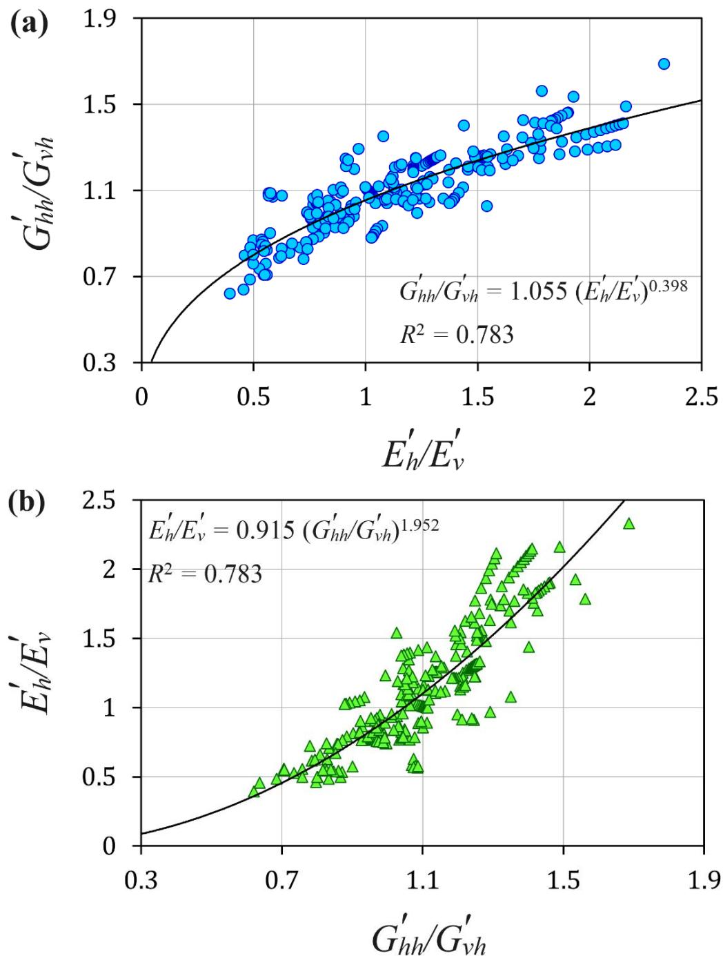
شکل ۲. ترسیم متقابل نسبت‌های ناهمسانگردی مدول برشی و مدول یانگ در برابر یکدیگر و ارزیابی همبستگی بین آن‌ها. (a) نمایش  $G'_{hh}/G'_{vh}$  به صورت تابعی از  $E'_h/E'_v$ ; (b) نمایش  $E'_h/E'_v$  به صورت تابعی از  $G'_{hh}/G'_{vh}$
