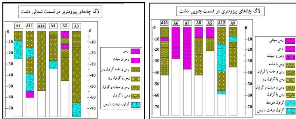
شکل ۲. لاگ چاه‌های مشاهداتی دشت اوان Fig.2. Log of observation wells in the Evan plain
