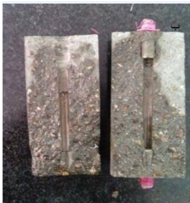
شکل ۱۰. بررسی تأثیر تنش قائم بر هندسه شکست هیدرولیکی (الف). نمونه مکعبی (ب). نمونه استوانه‌ای
