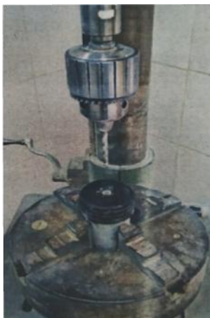
شکل ۲. سوراخ کاری نمونه‌های سیمانی
