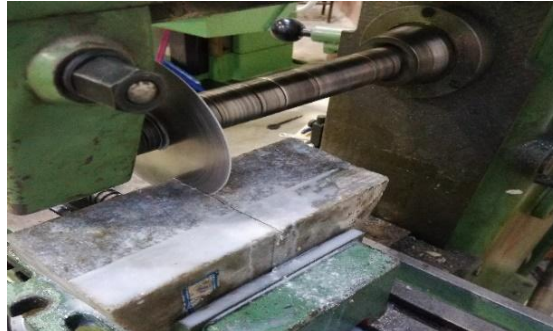
شکل ۳. نحوه ایجاد ترک در قطعات نیم‌دیسک
