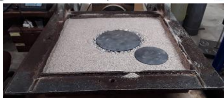
شکل ۹. آرایش قرارگیری ستون‌های سنگی منفرد الف) ۸/۴٪، ب) ۱۲٪، ج) ۱۶/۴٪، د) نمونه ساخته شده در دستگاه برش مستقیم
