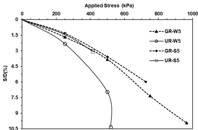
شکل ۸. میزان بار بر حسب  $S/D$ ، متناظر با سیکل آخر هر سطح بارگذاری برای ماسه لایروبی غیرمسلح و مسلح شده با ژئوسل با رویه شنی و رویه ماسه‌ای
