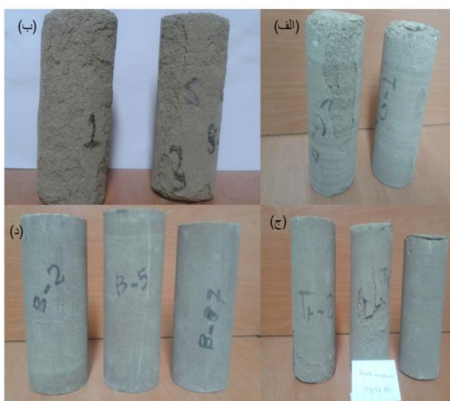
شکل ۷. تخریب نوع دوم (الف، ب، ج): تخریب پوست پیازی (جدا شدن سطوح نازک بیرونی از نمونه‌های سنگی)، (د) عدم تخریب نوع B در انتهای سیکل ۶۰ آزمایش ذوب-انجماد. (قطر نمونه‌ها ۵/۴ سانتی‌متر و طول آن‌ها ۱۴ سانتی‌متر است)
