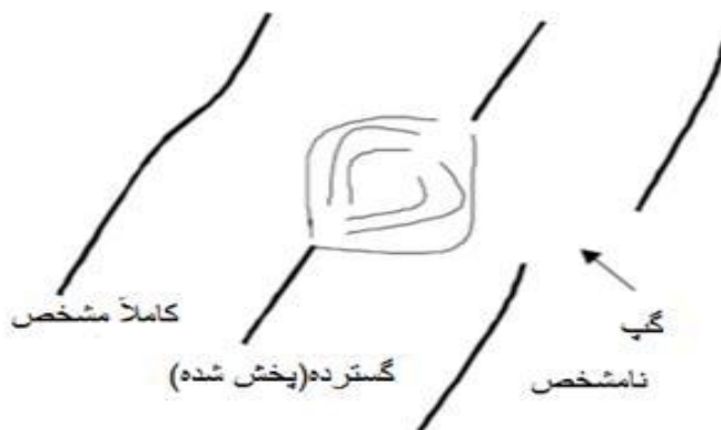
شکل ۳. رده‌بندی گسل‌ها براساس تظاهر سطحی [۲۴]
