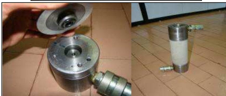
شکل ۲. سلول هوک و درپوش‌های ساخته شده برای مناسب‌سازی سلول برای آزمایش شکست هیدرولیکی
