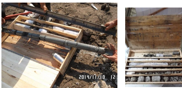
شکل ۸. جعبه نمونه محتوی مغزه‌های شکل ۹. مته سه جداره مغزه‌گیری به همراه محفظه به‌دست‌آمده از ستون L6-1 تا عمق ۶ متر
