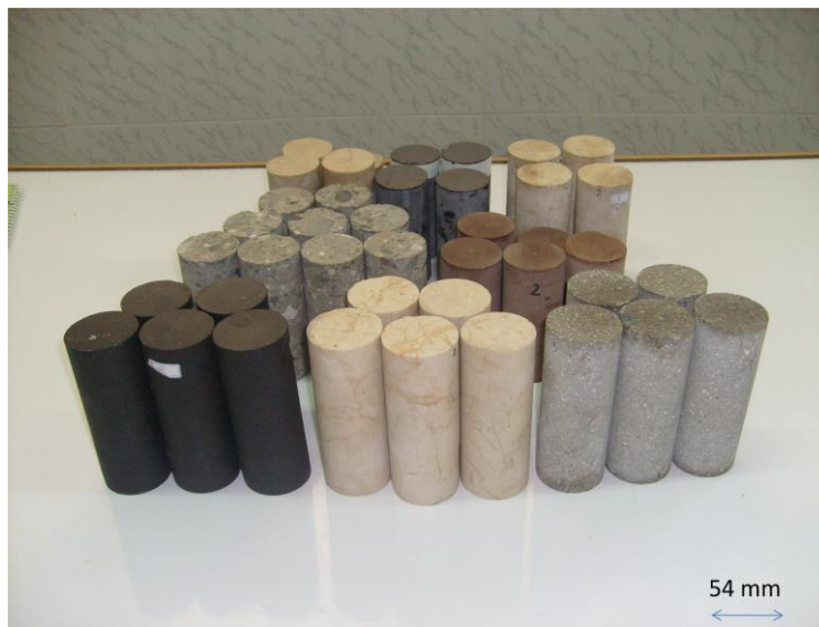
شکل ۶. مغزه‌های استوانه‌ای آماده‌سازی شده برای آزمایش اولتراسونیک
