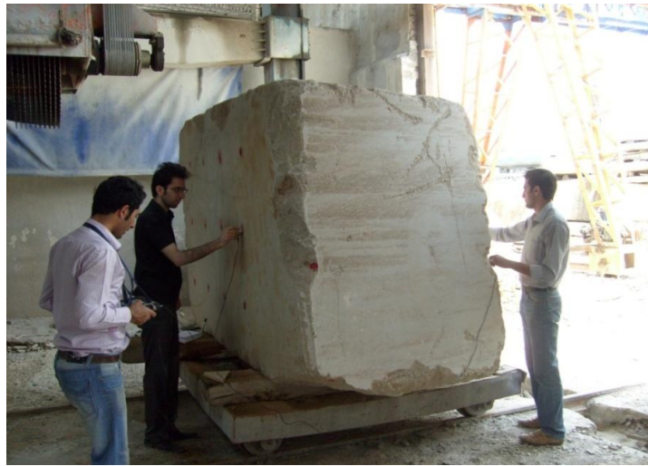
شکل ۳. انجام عملیات آزمایش بزرگ مقیاس سرعت عبور موج در نمونه مرمریت
