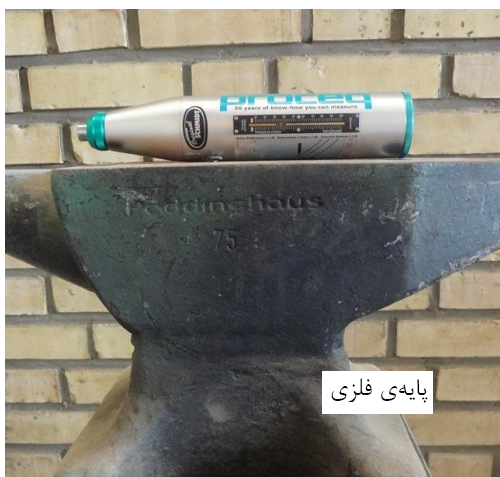
شکل ۲. چکش اشمیت به‌همراه پایه فلزی سنگین
