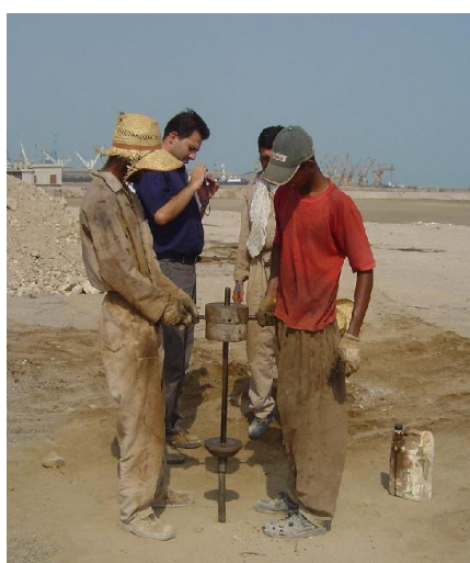
شکل ۲. ابزار کاوش‌گر دینامیکی دستی نوع متوسط [۴]
