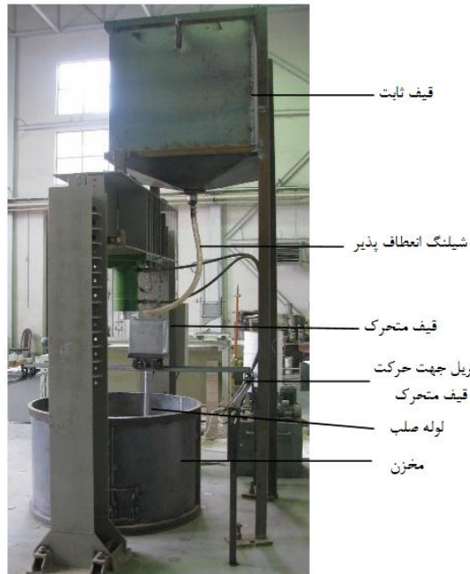
شکل ۲. نمای کلی از قیف اصلی و مخزن
