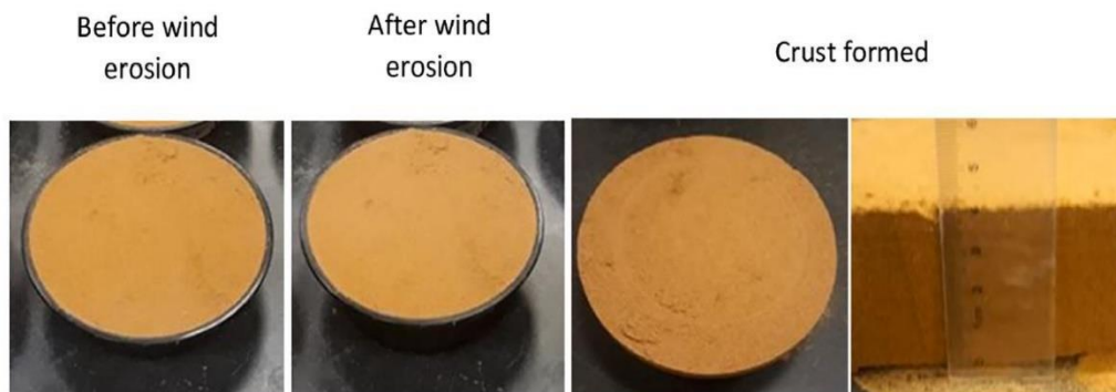
شکل ۸. تشکیل پوسته ماسه عمل‌آوری شده توسط گوار گام (Kavazanjian Jr et al., 2009)
